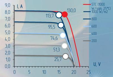
\* Для модели RZMP-130-T. Стандартные условия тестирования (STC): Облученность 1000 Bm/м², спектр АМ 1.5, 25°C. Кривые— при реальной температуре модуля в зависимости от облученности (температура воздуха 20°C)
