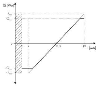
Figure 20: Limiting the parameter **Pmax** to the parameter **Qmax**
